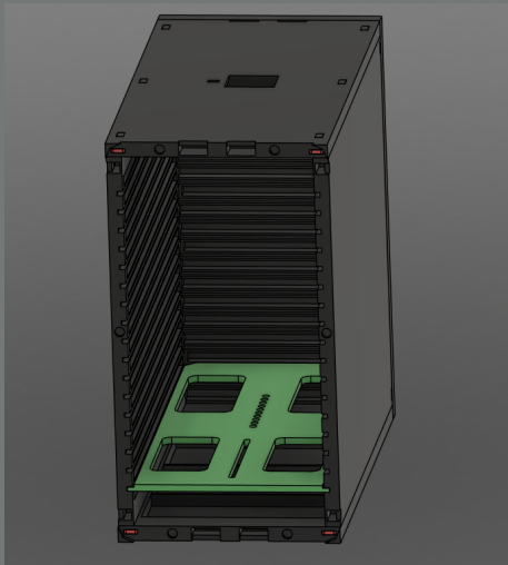
Abb. 5: SM geöffnet mit eingesetztem Slotcar-Träger.
